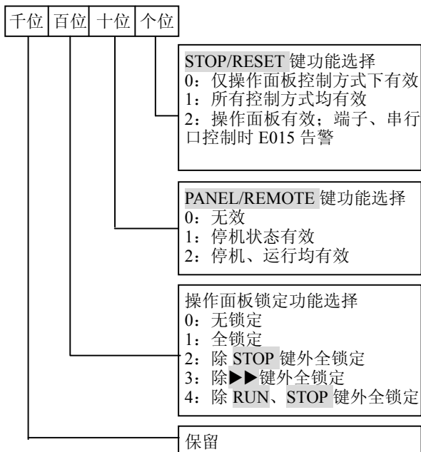
图5-64 操作面板按键功能及锁定选择设定
